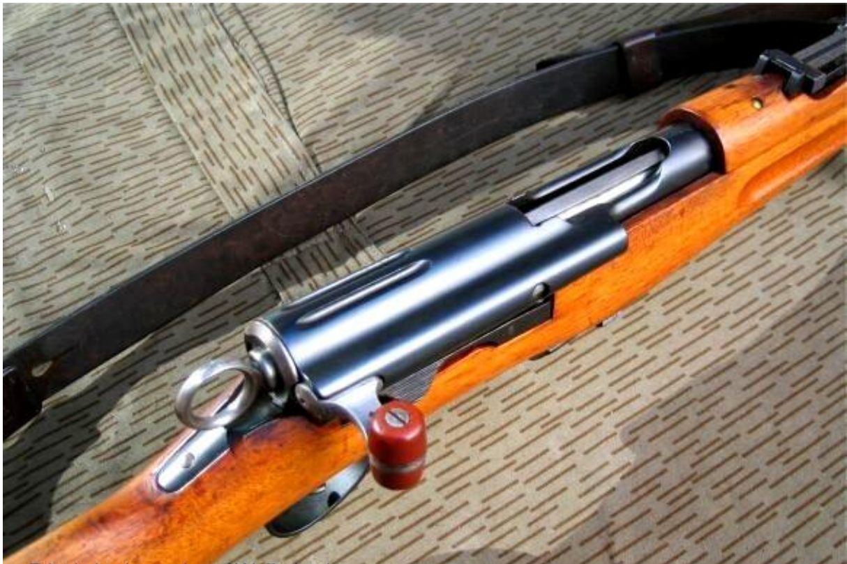
Karabiner 11 – Verschluss zu und entsichert
