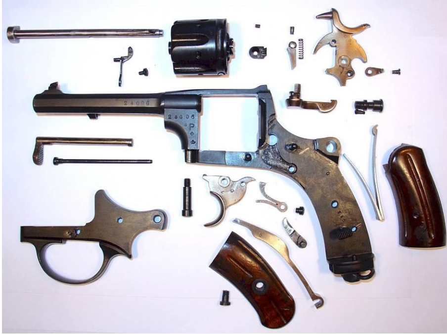
Ordonnanz-Revolver Modell 1882 – zerlegt in Einzelteile
